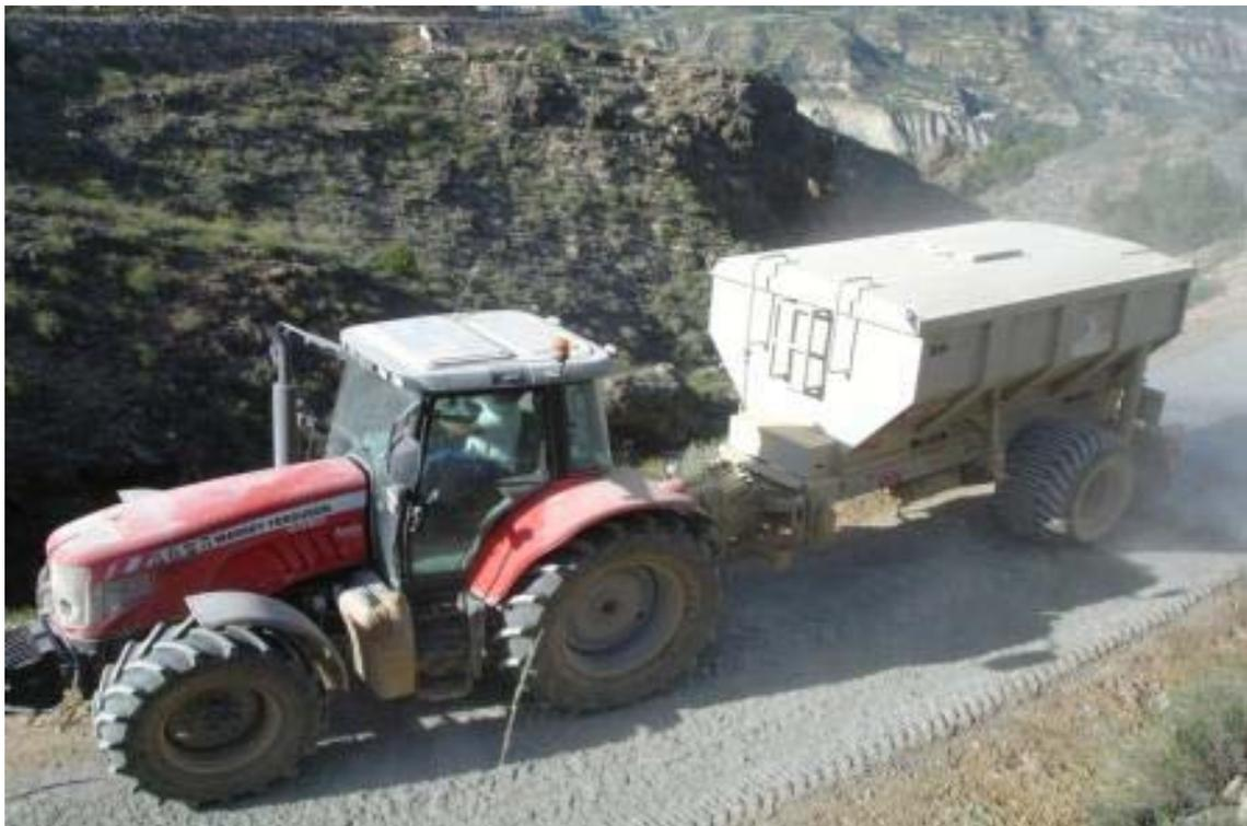
*Ilustración 10. Equipo repartidor de conglomerante remolcado por tractor*
